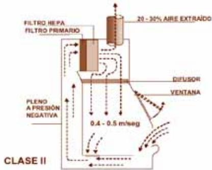
Protegen a los trabajadores de los materiales manipulados y a dichos materiales de la contaminación externa. No previenen de las exposiciones por contacto con materiales peligrosos.
